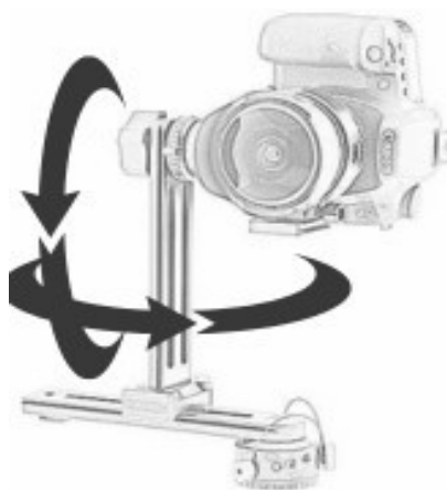
Figura 16 – Equipamentos necessários para montagem de costura panorâmica (Toscano et. al, (2024)
