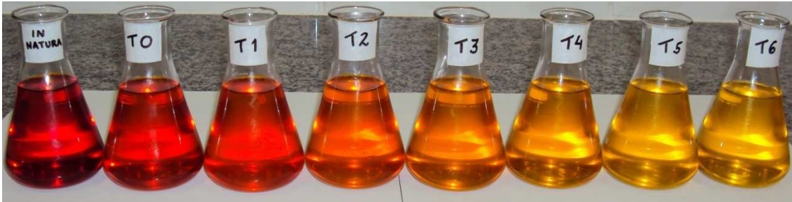
Figura 10. Amostras obtidas após aquecimento em temperatura de fritura (180 °C) com diferentes tempos de exposição (0 a 60 minutos).
