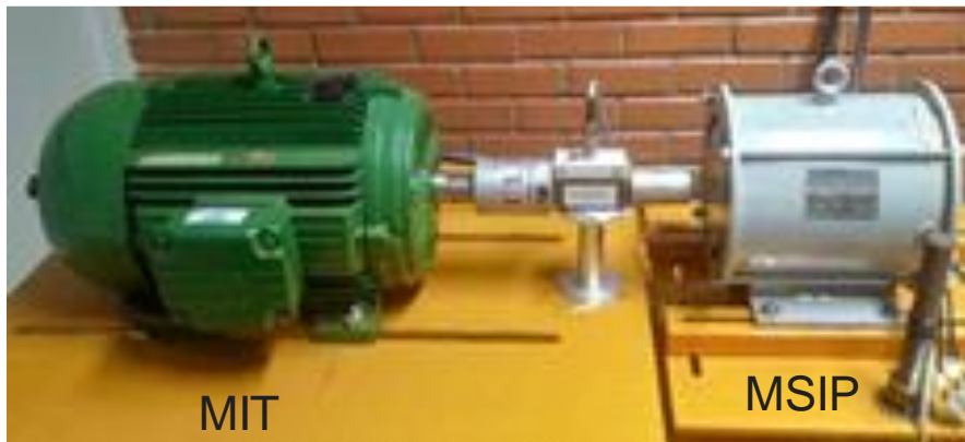
Figura 6.1 - Máquina Síncronas de Ímã Permanente no Rotor (cinza)
