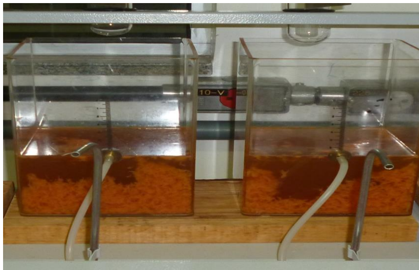
Figura 15 – Efluente real tratado via Reagente de Fenton em pH 3,0 e 3,5 em [\text{Fe}^{+2}] = 110,5\text{mg.L}^{-1} e [\text{H}_2\text{O}_2] = 500\text{mg.L}^{-1} .
