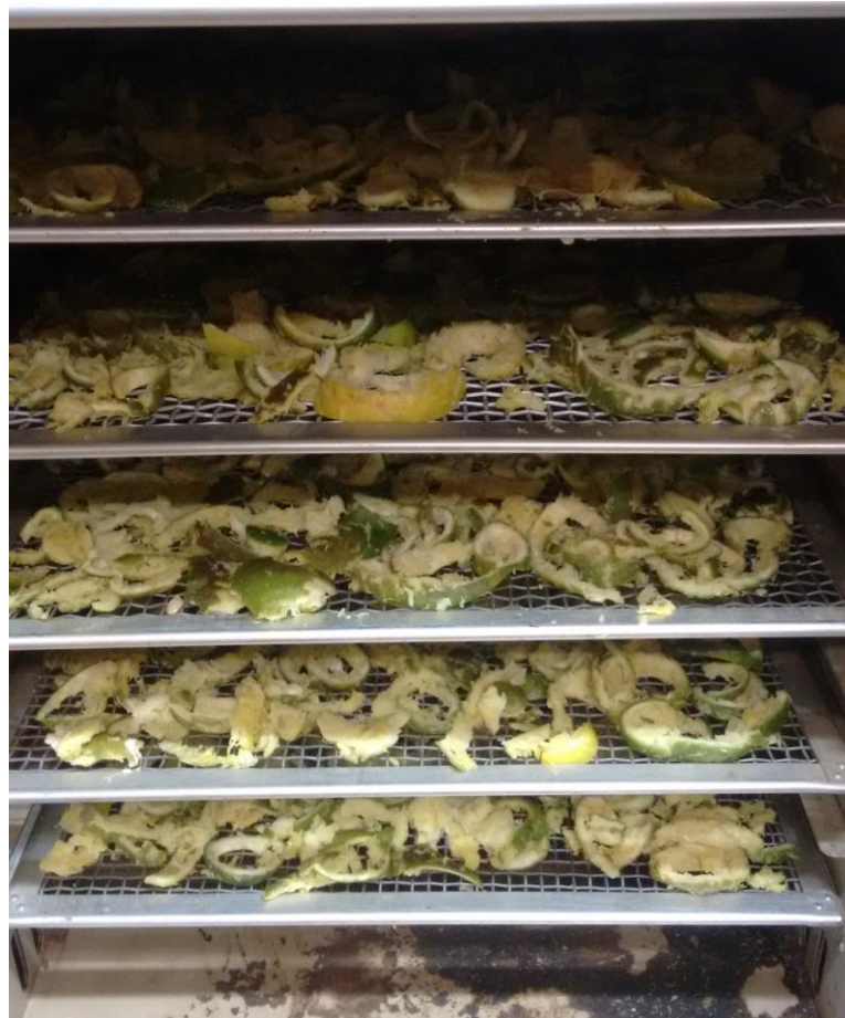
Figura 4.2: Bagaço de Laranja Disposto em Bandejas Dentro da Estufa Antes da Secagem.
