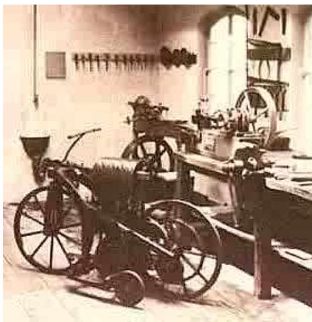
Figura 04: Motociclo de Gottlieb Daimler, patente nº 36.423 de 1885 (Alemanha) Fonte: França, 1979, p.15
