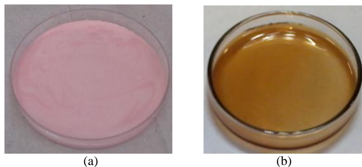
Figura 5.01 - (a) látex estabilizado com amônia em placa de petri e, (b) biomembrana polimerizada.
