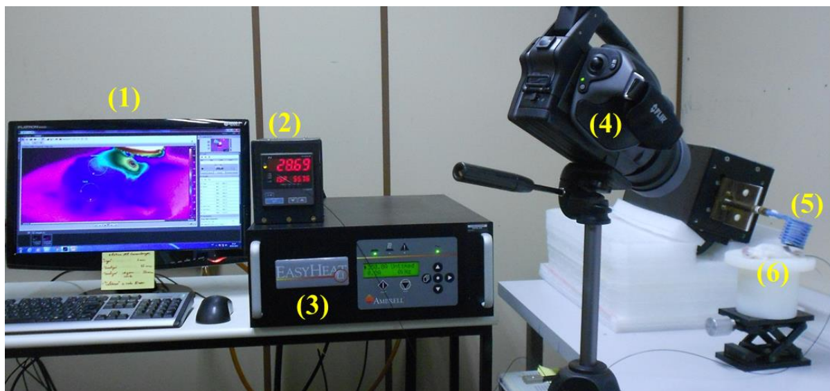
Figura 2.7 Primeira montagem experimental para realização de Hipertermia Magnética in vivo : (1) imagem termográfica da superfície da pele no camundongo durante o procedimento de HM com NPM; (2) registro do termômetro de fibra óptica (ponto sobre a pele na região do tumor subcutâneo); (3) gerador de campo magnético alternado; (4) câmera termográfica; (5) cabeçote com a bobina (indutor); (6) apoio para o camundongo montado sobre um elevador que permite seu movimento de aproximação da face da bobina (que fica voltada para superfície da pele do animal).
