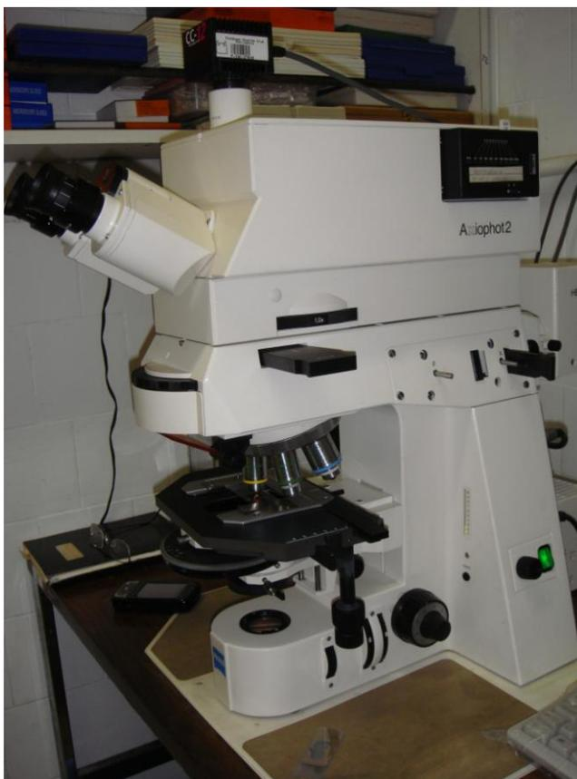
Figura 13. Microscópio Zeiss AxioPlan2 com sistema de captura de imagens AxioPhot2 utilizado na análise das lâminas dos olhos do estudo.
