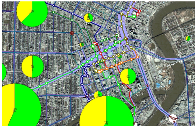
Figura 3.23: Software EMME 3 – exemplo de visualização de gráfico de pizza, definição de volume de trânsito (largura da rua) e também itinerários como as linhas verdes e vermelhas [120]
