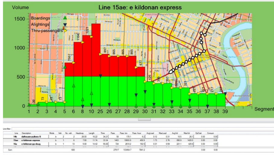
Figura 3.24: Software EMME 3 - cada segmento da rota mostra a quantidade de passageiros em pé ou sentados. O gráfico de barras de coloração vermelha indica um número além da capacidade normal [120]
