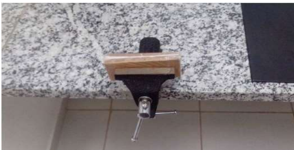
Fig.4 Morsa para impressão de cutícula. Dois pedaços de madeira previamente revestidos com isopor e fita adesiva prensam a lâmina com uma camada de esmalte contra o(s) pelo(s) guarda(s) que são impressos no esmalte
