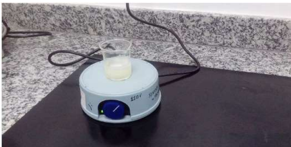
Fig.3 Lavagem de pelos guarda utilizando agitador magnético
