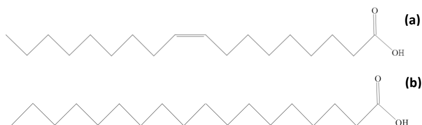
Fig. 4.5. Estrutura molecular do surfactante orgânico (a) ácido oleico e (b) esteárico utilizado para o recobrimento das partículas.
