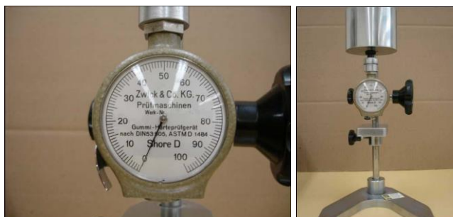
Figura 2. 13 – Exemplo de um equipamento usado na medição da dureza
