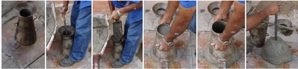
Figura 3. 5 – Sequência do “slump test”
