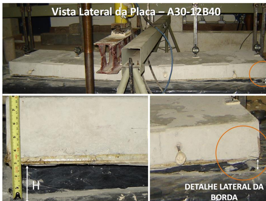
Figura 4.45 – Levantamento das bordas no ensaio da placa A30-12B40
