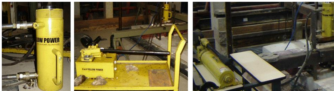
Figura 3. 18 –Atuador hidráulico Yellow Power (Capacidade 300 kN)
