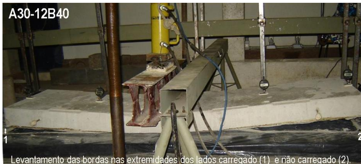
Figura 4. 8 – Levantamento das bordas externas da placa A30-12B40
