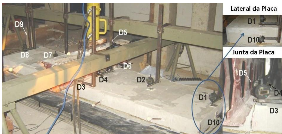
Figura 3. 20 – Posicionamento dos deflectômetros digitais na placa de concreto
