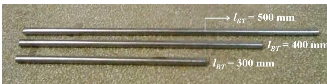
Figura 3. 8 – Barra de transferência redonda \varnothing 12,5mm ( l_{BT} = 500, 400 e 300 mm)
