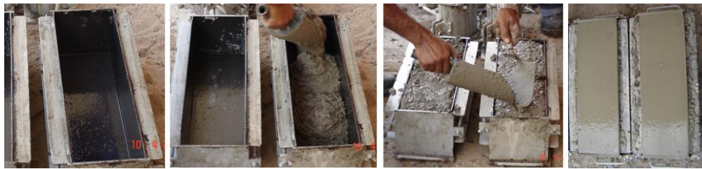
Figura 3. 6 – Moldagem de vigas 150 mm x 150 mm x 500 mm
