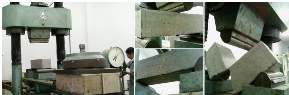
Figura 3. 7 – Ensaio de tração na flexão
