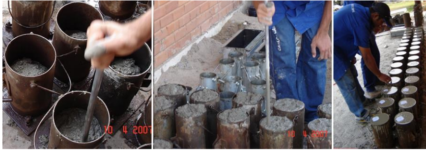
Figura 3.4 – Moldagem dos corpos de prova cilíndricos
