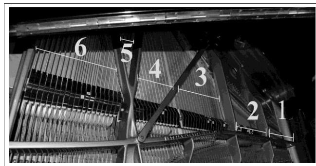
Ilustração 5: Divisões da armação de metal do piano usado para esta pesquisa.
