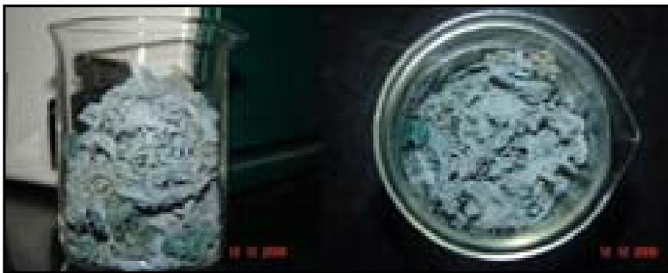
*Figura 5.2: Amostras oriunda dos fulões, denominadas neste trabalho como “rebarba dos fulões”, devidamente preparadas para análises laboratoriais.*
