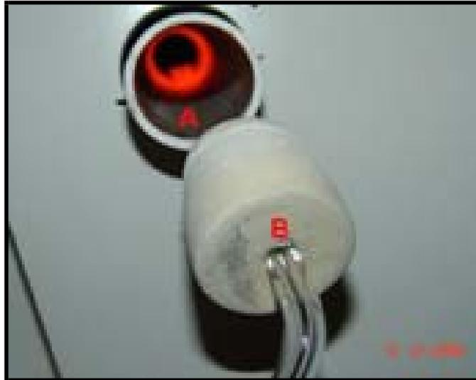
**Figura 5.8:** Visualização da câmara aquecida pelo forno, onde as amostras de resíduos foram analisadas. **A)** Câmara de porcelana aquecida a 1.000 °C; **B)** Material emborrachado usado para evitar a saída de gases durante a combustão, podemos observar também uma tubulação em seu centro onde foi injetado ar graças ao compressor, onde os gases gerados durante a combustão do resíduo eram arrastados para o sentido oposto da tubulação, com o intuito de captação dos mesmos.
