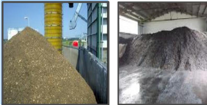
**Figura 4.11:** Lote de blending devidamente formulado quimicamente e fisicamente para alimentação dos fornos de fabricação de cimento como combustível alternativo (SIMAI, 2004).
