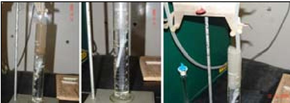
**Figura 5.15:** Processo de captação dos gases oriundos da combustão no interior do forno, lembrando que para cada tipo de amostra foram utilizadas soluções ácidas, básicas e neutras para a captação dos gases.
