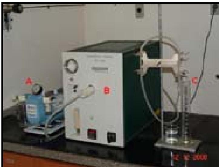
**Figura 5.5:** Projeto piloto para a destruição térmica dos resíduos. **A)** Compressor para o arraste dos gases gerados durante a combustão no interior do forno; **B)** Forno adaptado para a combustão a 1.000 °C; **C)** Captação dos gases.
