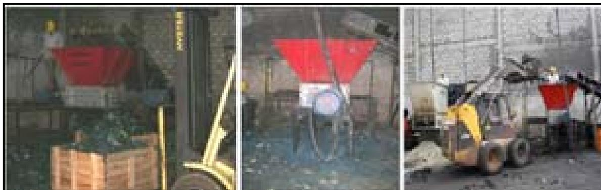
**Figura 5.3:** Processo de trituração dos resíduos utilizados durante o experimento, onde os resíduos tiveram sua granulometria reduzida para ser incorporado ao lote de blending.
