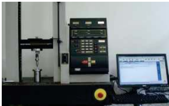
Artigo Figura 3 – Máquina de Ensaio Universal Instron
