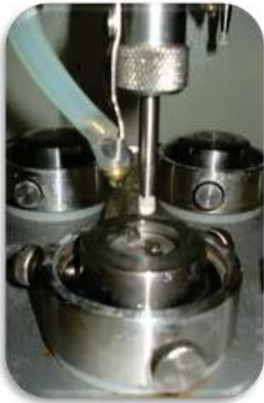
Artigo Figura 5 – Ponta ativa e irrigador do equipamento de desgaste Termomecânico.
