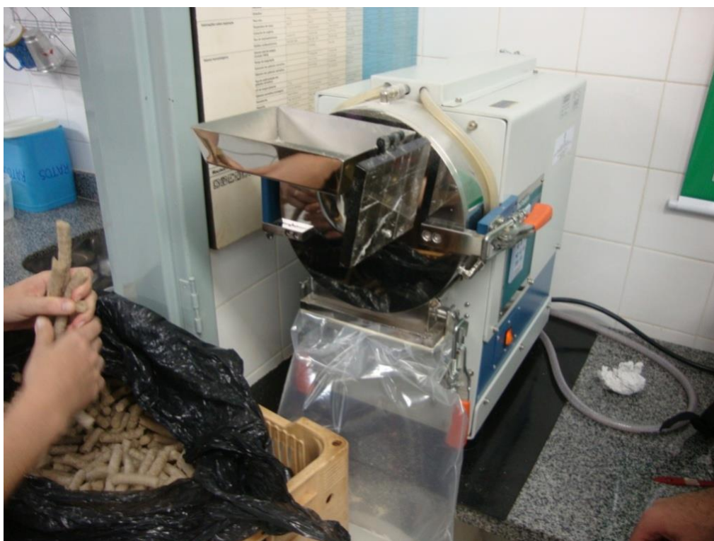
Figura 2: Moagem dos extrusados para obtenção das farinhas pré-gelatinizadas
