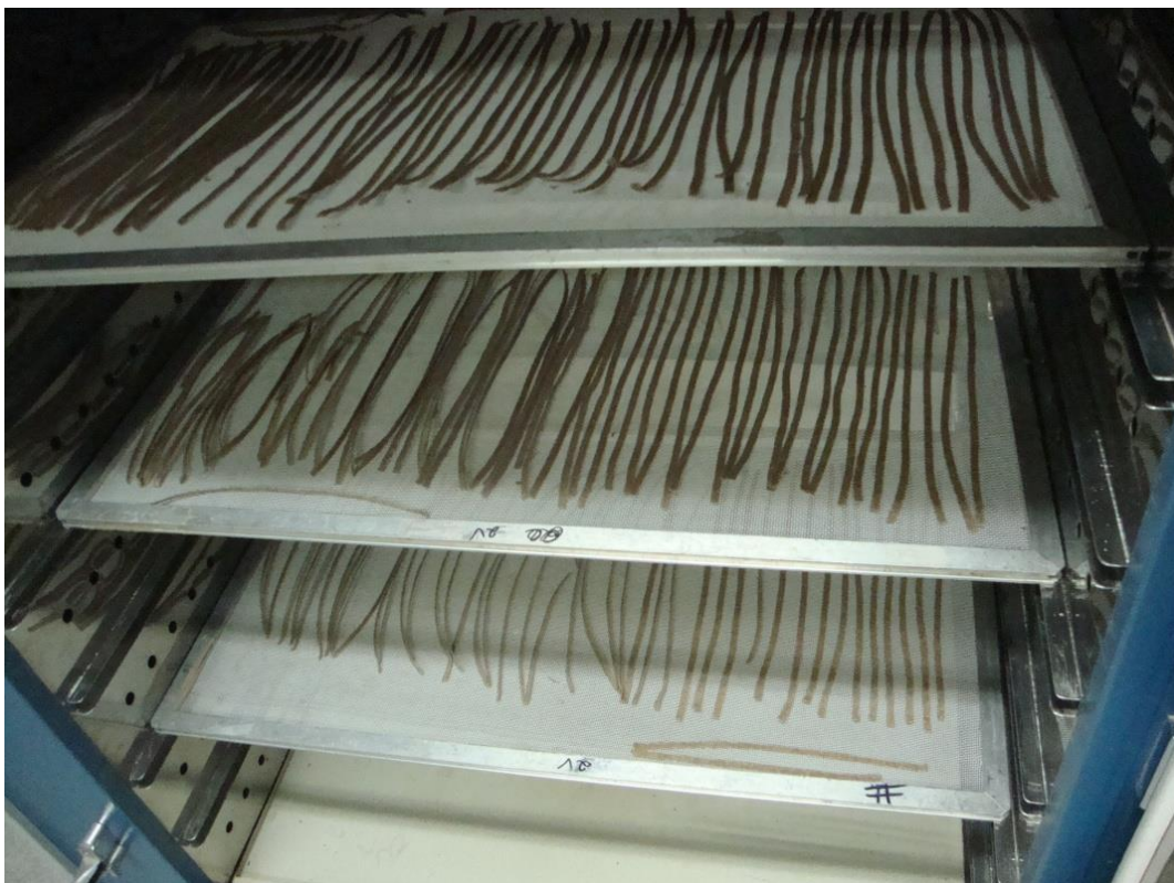
Figura 8: Secagem das massas em estufa de circulação de ar a 45 °C
