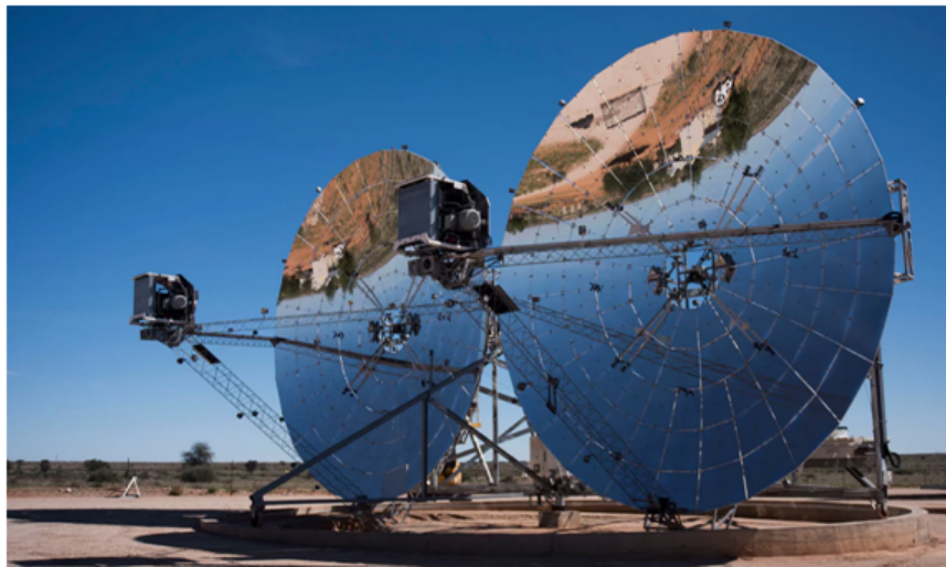
Figura 3 – Motor Stirling com acionamento a partir de energia solar
