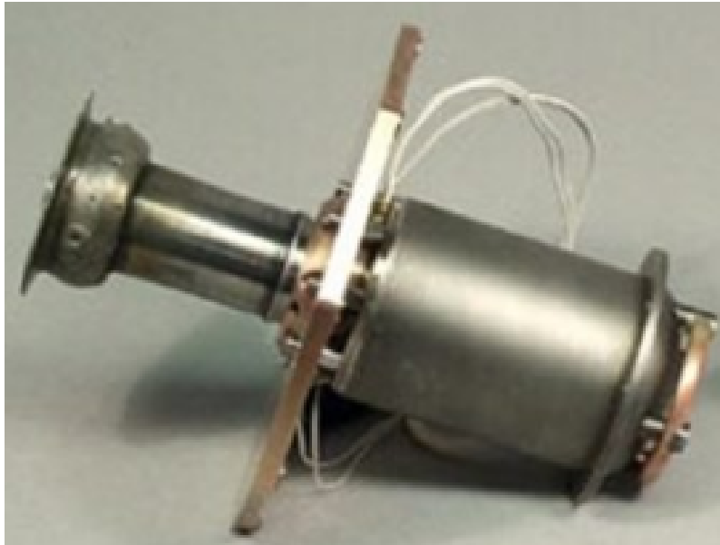
Figura 4 – Motor Stirling com acionamento a partir de combustível nuclear
