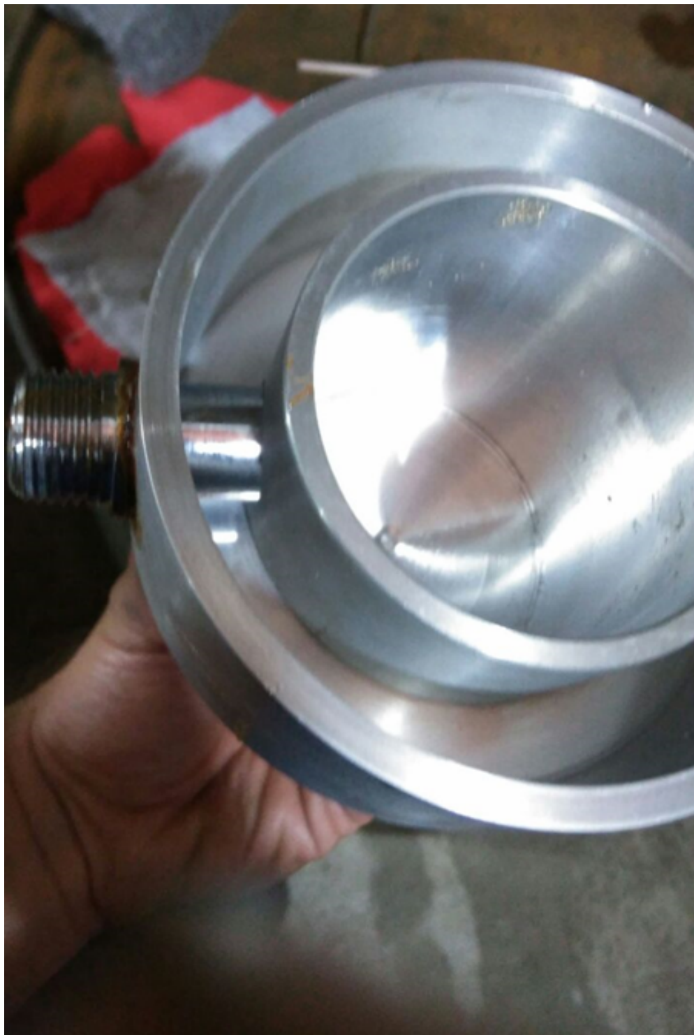
Figura 24 – Cilindro de expansão com arrefecimento feito por água
