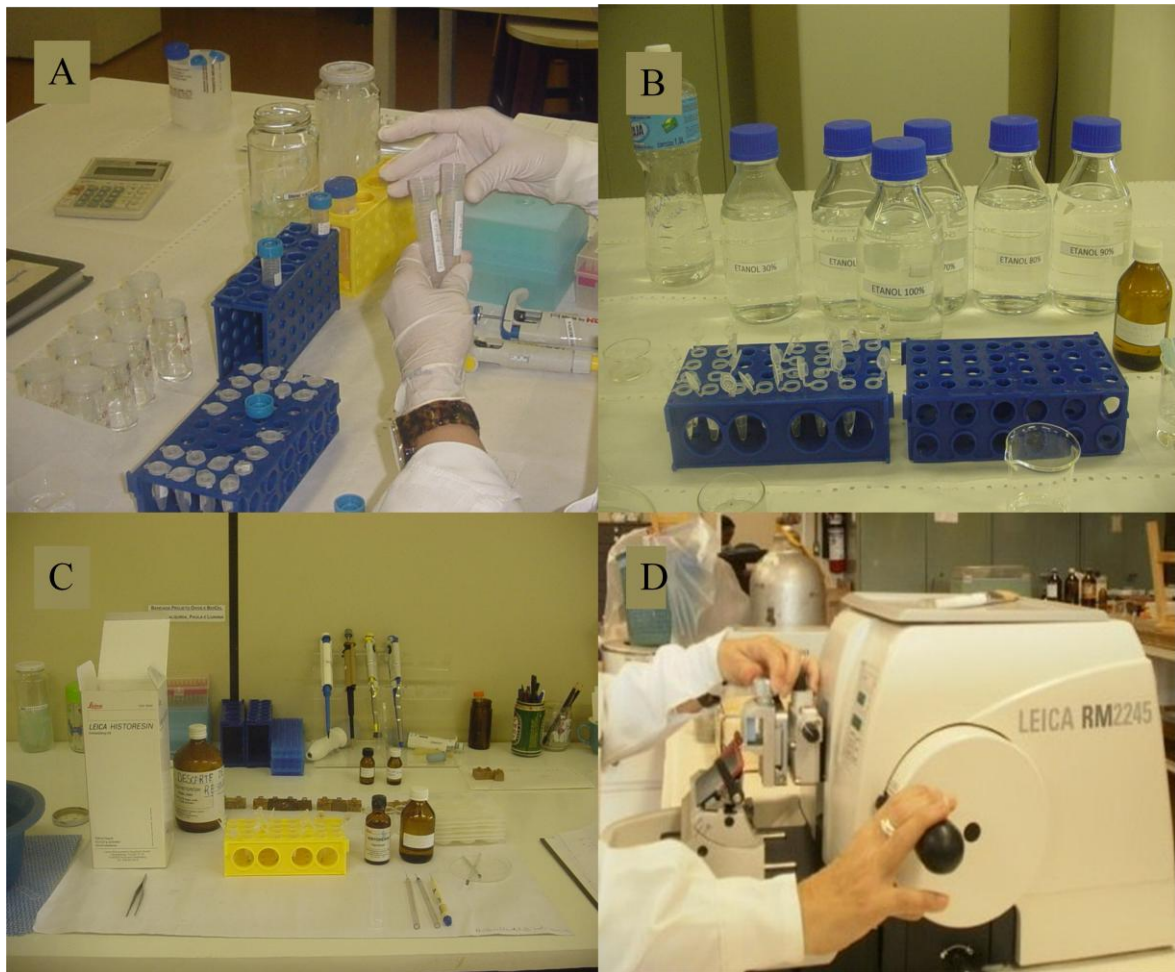
Figura 5. Processamento das amostras para microscopia de luz. A - lavagem e fixação das larvas de terceiro estágio de Aedes aegypti . B – desidratação das larvas. C - infiltração e inclusão das larvas em resina. D - corte dos blocos de resina em micrótomo.
