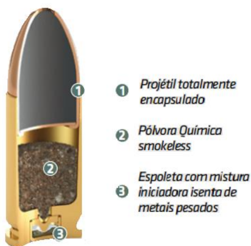
Figura 4 - Cartucho de arma de fogo 9mm fabricação CBC e seus elementos
