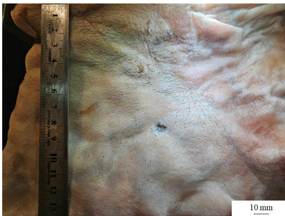
Figura 34 - Disparos realizados a 30 cm de distância entre atirador e alvo em carcaça com 20cm x 20cm de dimensão.
