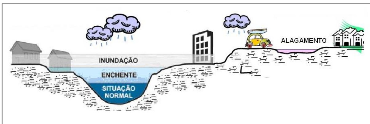
FIGURA 27: PERFIL ESQUEMÁTICO DO PROCESSO DE ENCHENTE, INUNDAÇÃO E ALAGAMENTO - 2018
