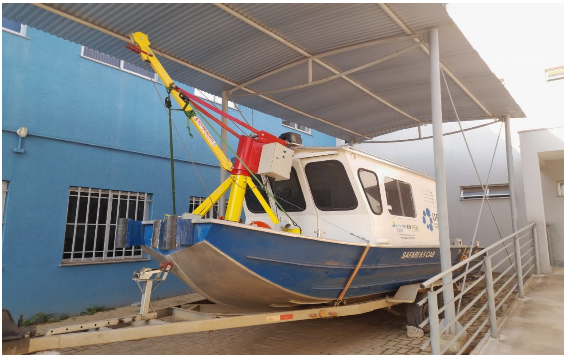
Anexo nº 1: Barco usado para levantamento batimétrico
