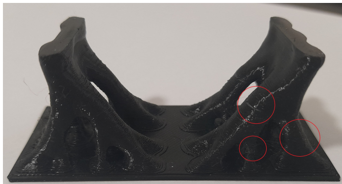
Figura 4.26: Ponte TO após ensaio
