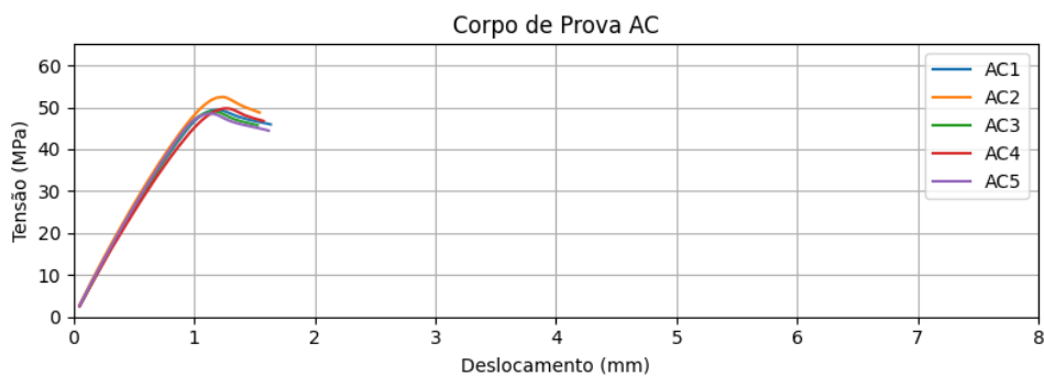
Figura J.5: Corpos de prova AC sem extensômetro e célula de 50 kN
