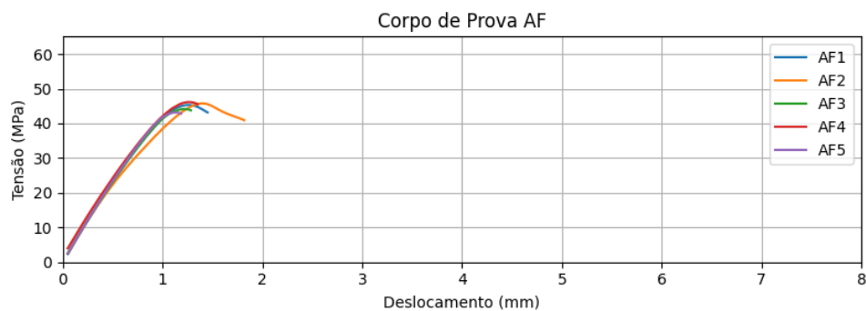
Figura J.11: Corpos de prova AF sem extensômetro e célula de 50 kN
