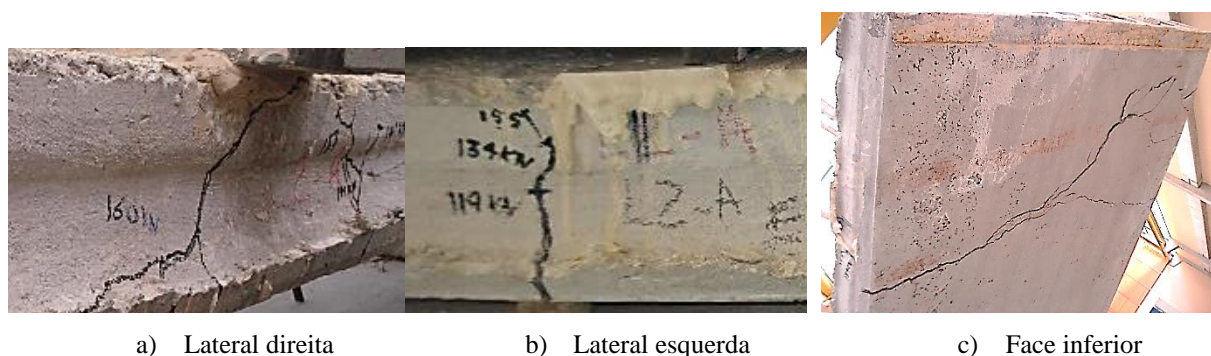
Figura 5.21 - Ruptura do modelo M2-0-5-50-N.
