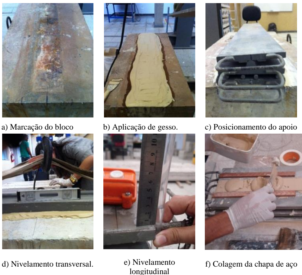
Figura 4.21 – Marcações no bloco de concreto e posicionamento do aparelho de apoio.
