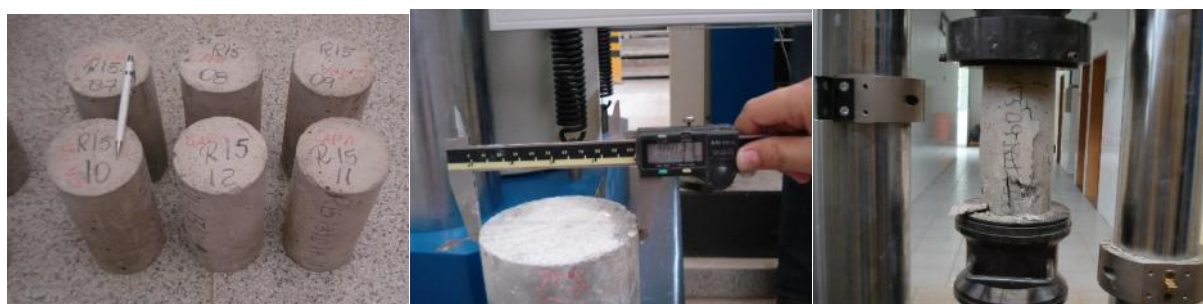
Figura 4.14 – Ensaio de resistência a compressão
