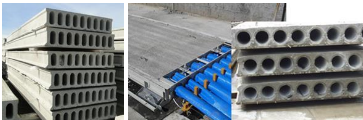
a) Lajes produzidas por formas deslizantes
