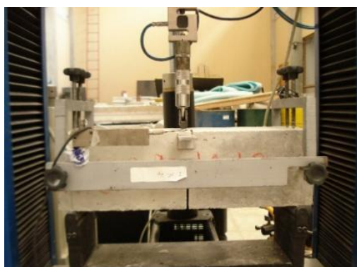
Figura 4.15 – Ensaio de flexão sob três pontos de carga com entalhe no meio do vão
