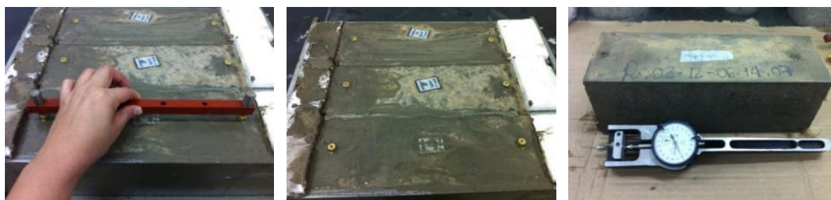
Figura 4.5 - Posicionamento dos pinos nos corpos de prova para o ensaio de retração hidráulica.
