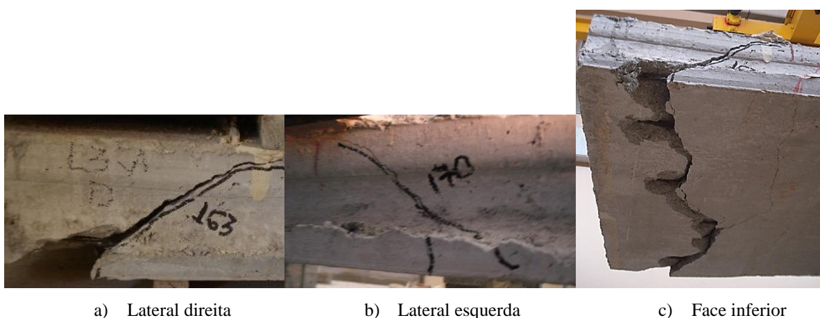
Figura 5.22 – Ruptura do modelo M2-0-3-50-S.
