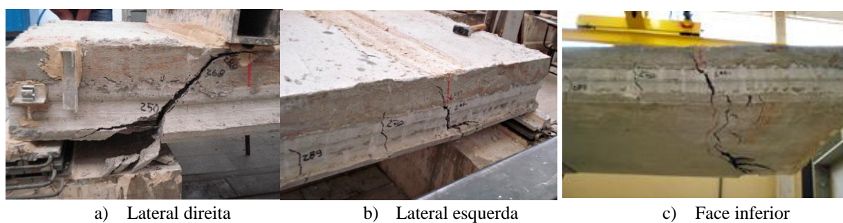
Figura 5.17 – Ruptura do modelo M2-9-0-B*.
