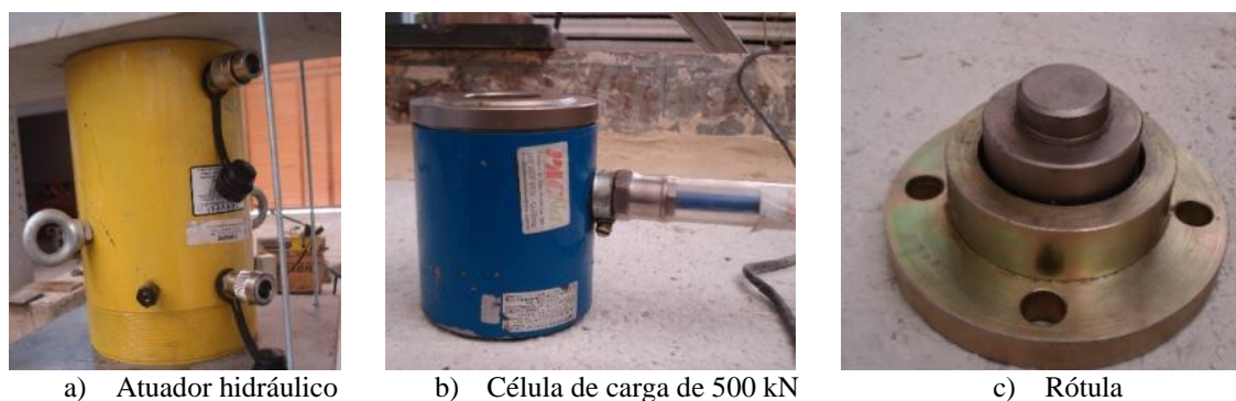
Figura 4.24 – Itens do sistema de aplicação do carregamento.
