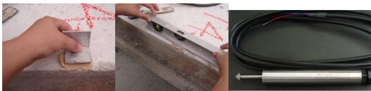
Figura 4.26 – Chapas auxiliares para posicionamento dos transdutores e modelo de transdutor utilizado.
