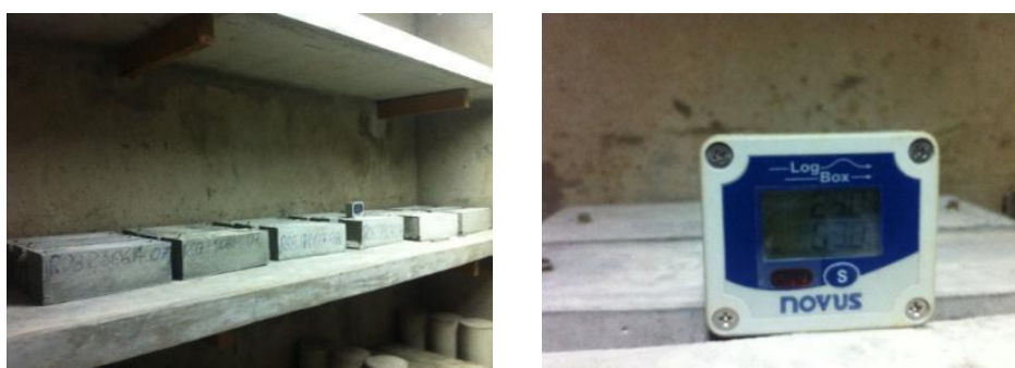
Figura 4.6 - Acondicionamento dos corpos de prova de retração hidráulica para acompanhamento e leitura.
