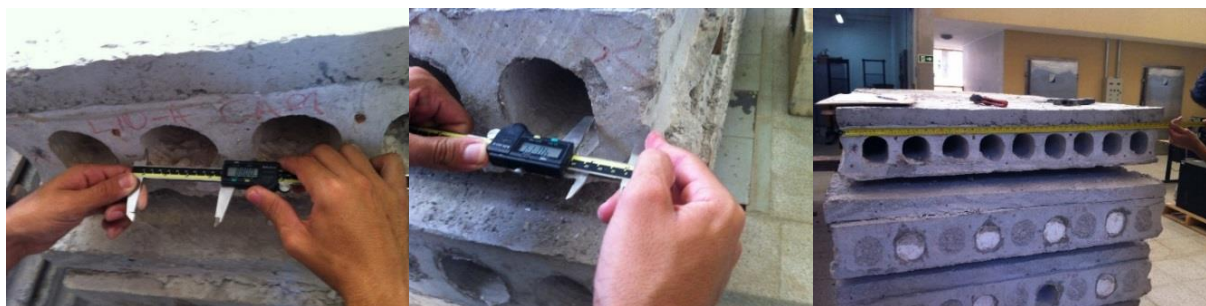
Figura 4.2 - Medições das dimensões lajes.
