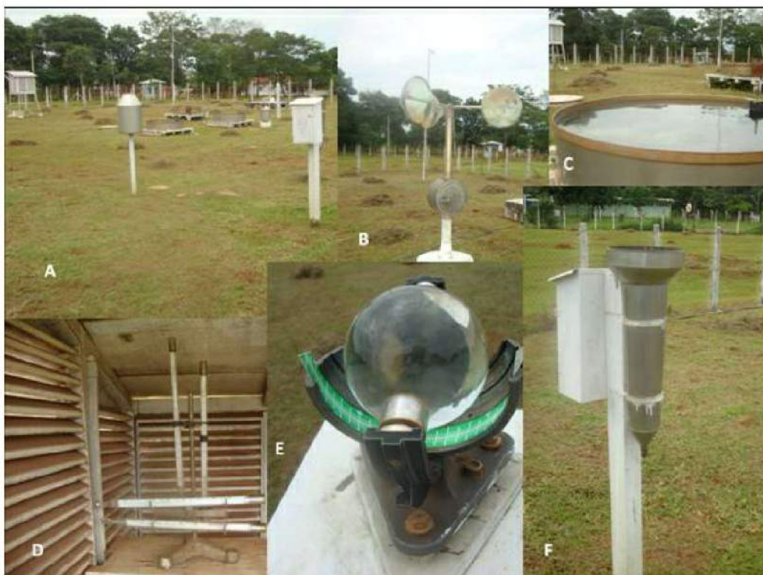
Figura 3. Estação meteorológica (A) da Escola de Agronomia e Engenharia de Alimentos da UFG (Lat: 16^{\circ}41''\text{S} , Long: 49^{\circ}17'' \text{W} , altitude: 741 m, Goiânia-GO), implantada em área gramada e equipada com: anemômetro (B), tanque classe A (C); abrigo meteorológico com paredes tipo venezianas com termômetros de máxima e mínima, e piscicrômetro de ventilação natural (D); heliógrafo - Campbell-Stokes (E) e pluviômetro - Ville de Paris (F).
