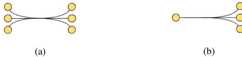
Figura 3.2: Tipos de feixes: (a) múltiplos vértices de origem e destino; (b) um vértice comum.
