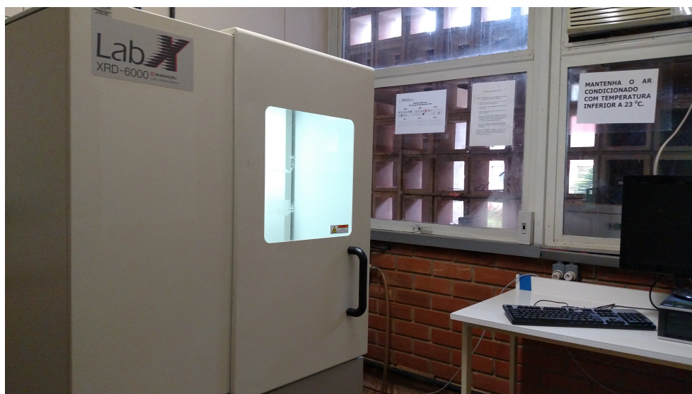
Figura 4.1: Equipamento de difratometria de raios-X instalado na central Analítica do Instituto de Química da UFG.
