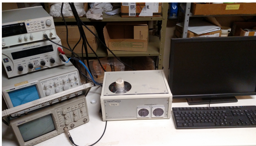
Figura 4.5: Equipamento de Magnetohipertermia instalado no Instituto de Física da UFG.
