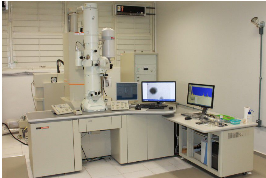
Figura 4.2: Microscópio eletrônico de varredura instalado no Laboratório Multiusuário de Microscopia de Alta Resolução (LabMic)
