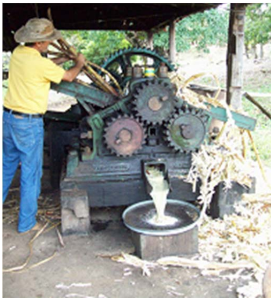
Figura 5: Extração do caldo de cana-de-açúcar.
