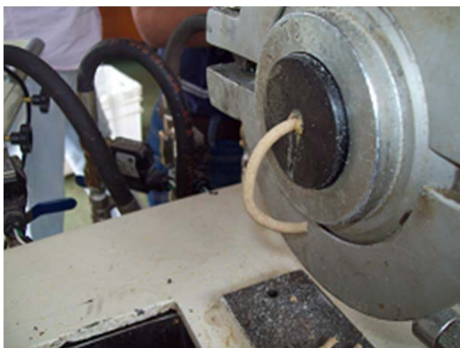
Figura 4: Saída do extrusado pela matriz de 4 mm.
