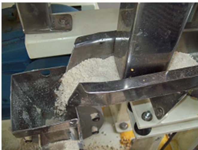
Figura 3: Saída do farelo in natura do silo de alimentação da extrusora monorosca PQ-30.
