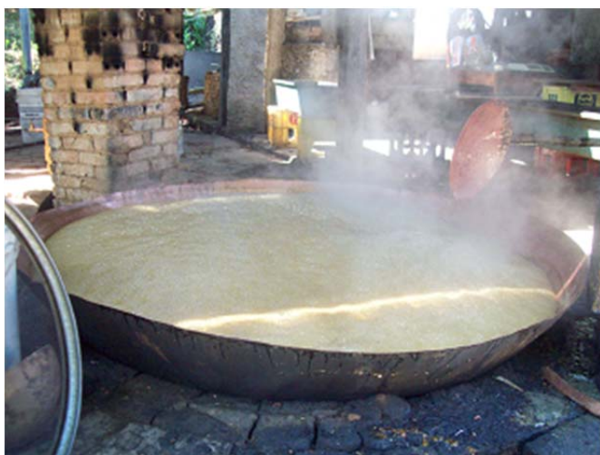
Figura 6: Concentração do caldo de cana-de-açúcar.
