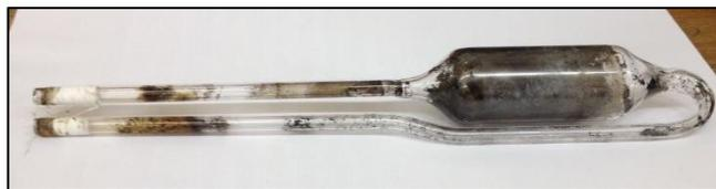
Figura 9 - Reator em aço inox utilizado na produção de carvão ativado por ativação química.
