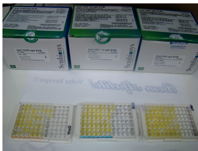
Figura 10- Demonstração dos kits e placas do ensaios imunoenzimático com intensidade de cor desenvolvidas no final da reação.
