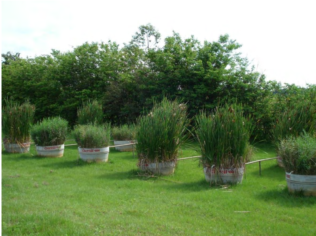
Figura 24 Estação de tratamento de esgoto por plantas em 08/12/2008 (Data da última coleta de amostras para análises).
