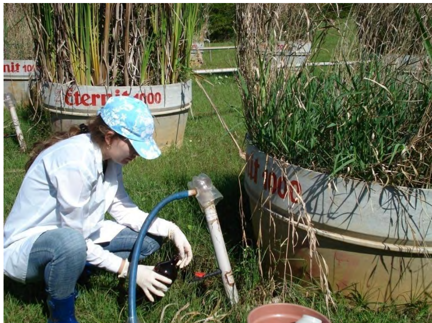
Figura 25 Coleta no registro amostrador do módulo final cultivado com caníço, no dia 13 de maio de 2008.
