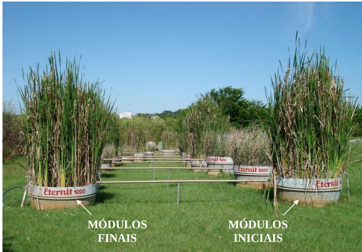
Figura 18 Detalhe do posicionamento dos módulos de tratamento no primeiro plano vegetados com taboa.
