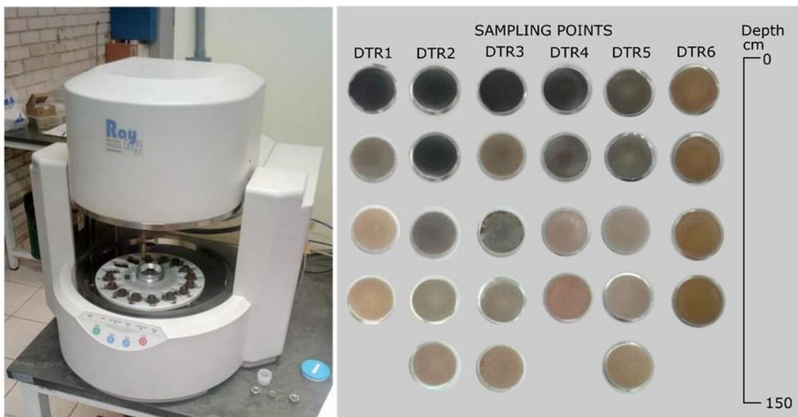
Para análise da composição mineralógica do solo, foram realizadas análise de Difração de Raios-X, utilizando porta-amostra de preenchimento frontal, conforme os procedimentos preconizados em Buhrke (et al. 1998). Utilizou-se um equipamento Bruker D8 Advance equipado com tubo de cobre, fenda Soller e detector linear ultrarrápido LynxEye, operando a 40 kV e 40 MA. Os perfis foram adquiridos entre 5 e 60 graus, com passos de 0,02 graus e tempo de aquisição por passo de
