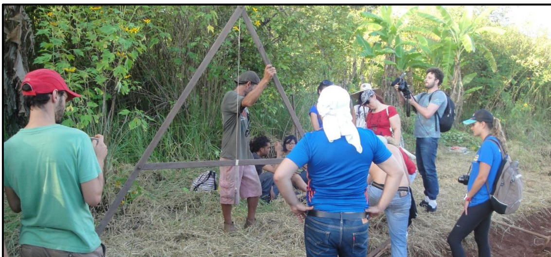
Figura 74 – Demonstração de uso do “pé-de-galinha” para definição das curvas de nível no terreno
