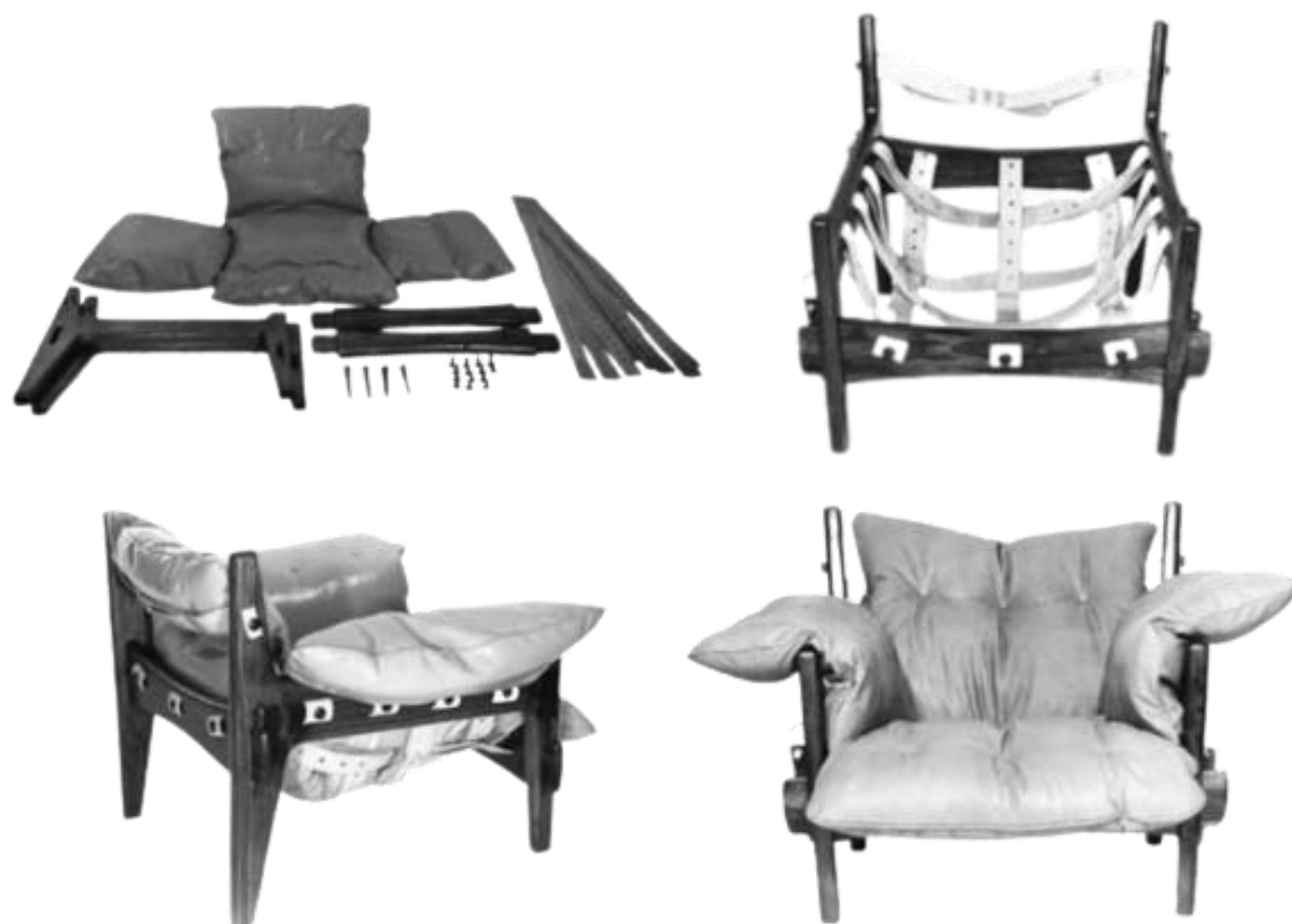
Figura 153: Fotografia da Poltrona Molex ilustrando a possibilidade de montar e desmontar do móvel. Fonte: Luz (2018, p. 143).
