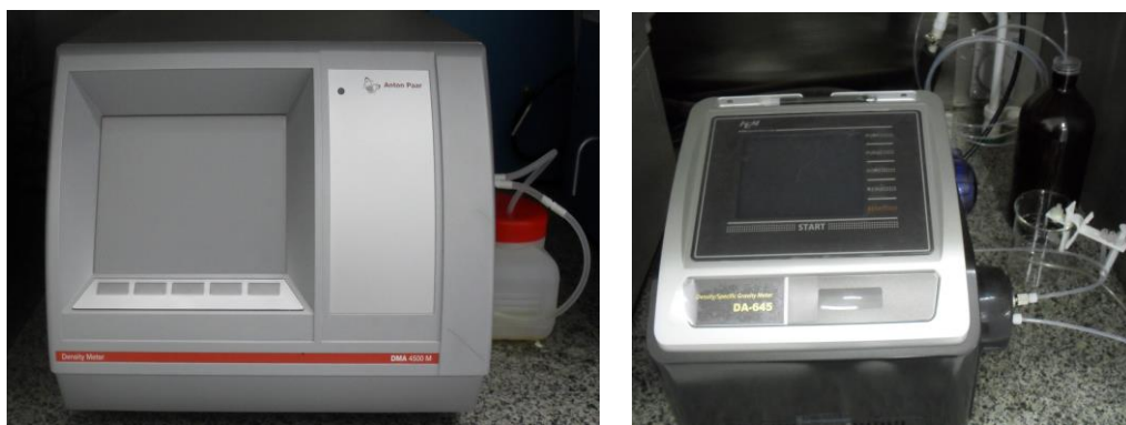
Figura 10. Densímetro Digital Anton Paar DMA 4500 e KEM DA-645
