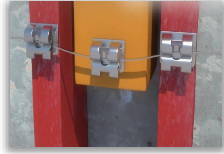
Figura 12. Ensaio de flexão em três bráquetes.
