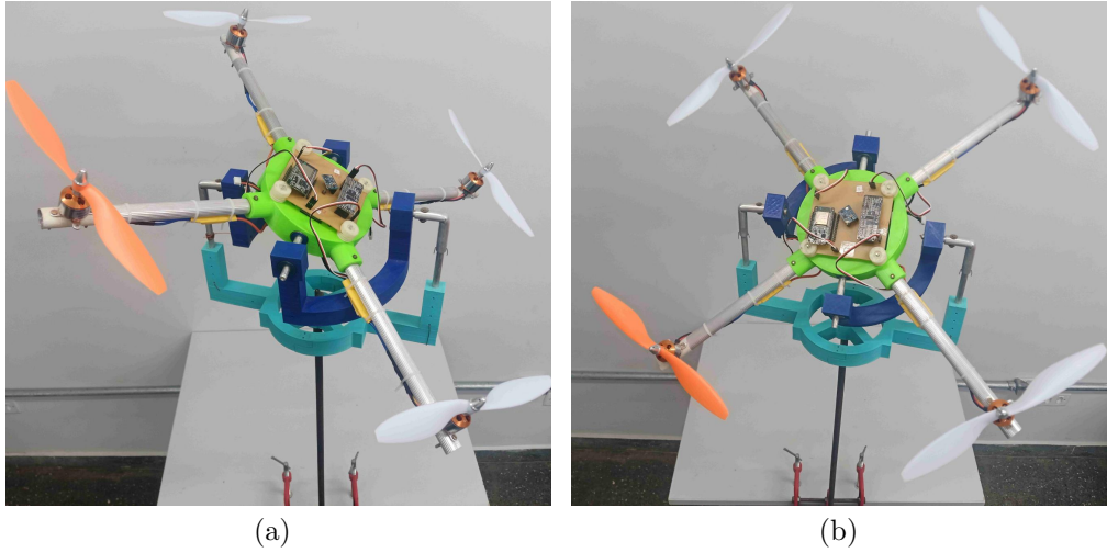
Figura 6.15 - Protótipo da bancada com quadricóptero inclinado: (a) quadricóptero inclinado em relação aos Suportes, e (b) quadricóptero não inclinado em relação aos Suportes.
