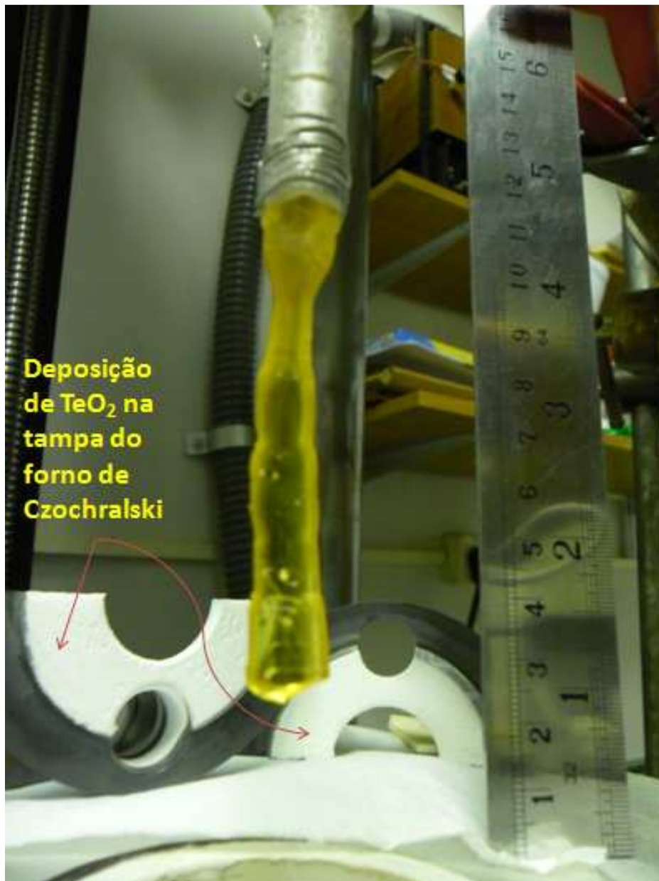
Figura 3.11 – Cristal de \text{BTeO} , como crescido, obtido pelo método de Czochralski modificado com taxa de rotação de 15 rpm e velocidade de puxamento de 0,27 mm/h em uma semente monocristalina orientada na direção \langle 001 \rangle . O cristal apresenta dimensões aproximadas de 50 mm na direção de crescimento, 9 mm na direção \langle 010 \rangle e 5 mm na direção \langle 100 \rangle . O processo de crescimento durou 189 h. Destaque para o \text{TeO}_2 depositado na tampa do forno.
