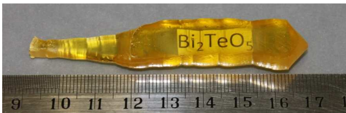
Figura 3.12 – Cristal de \text{Bi}_2\text{TeO}_5 , como crescido, obtido pelo método de Czochralski modificado com taxa de rotação de 15 rpm e velocidade de puxamento de 0,31 mm/h em uma semente monocristalina orientada na direção \langle 001 \rangle . O cristal apresenta dimensões aproximadas de 70 mm na direção de crescimento, 11 mm na direção \langle 010 \rangle e 7 mm na direção \langle 100 \rangle . O processo de crescimento durou 183 h.
