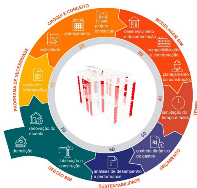
Figura 3.3-10 Processo da construção digital em BIM Fonte: adaptado de InsitecaBIM
