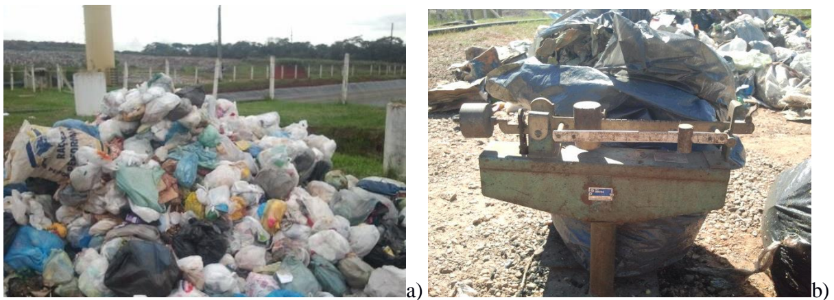
Figura 9 (a) Resíduos descarregados pelo caminhão coletor (b) Pesagem dos resíduos para lançamento nas trincheiras
