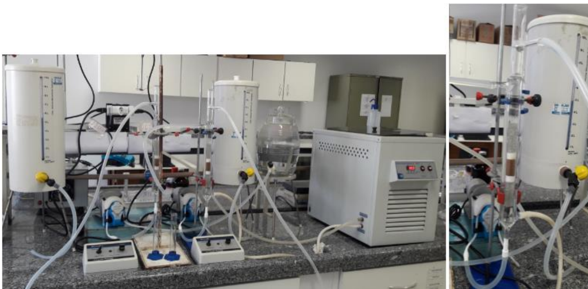
Figura 3.2 - Coluna de adsorção e equipamentos auxiliares.
