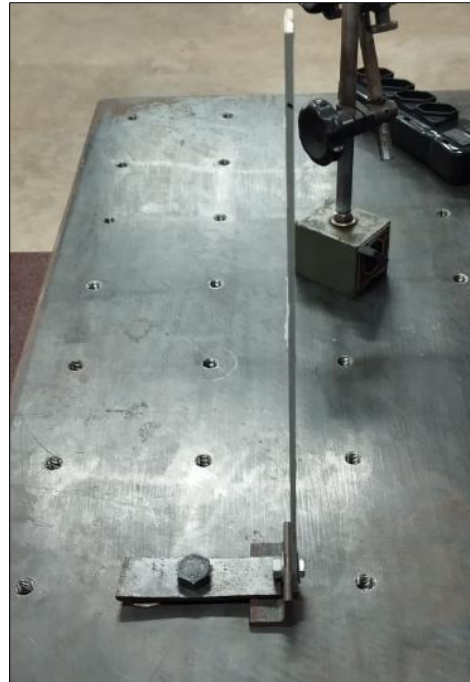
Figura 28: Viga fixada na mesa inercial.
