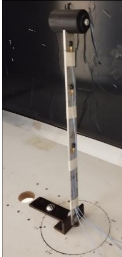
Figura 23: Implementação de massa concentrada na viga.
