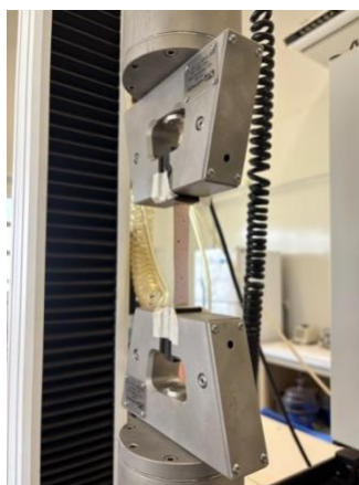
Figura 7. Máquina universal de ensaios Instron utilizada para análise de resistência à tração de filmes. Fonte: A autora (2024).
