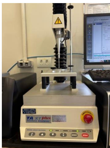
Figura 8. Texturômetro utilizado para a análise de resistência à perfuração de filmes. Fonte: A autora (2024).
