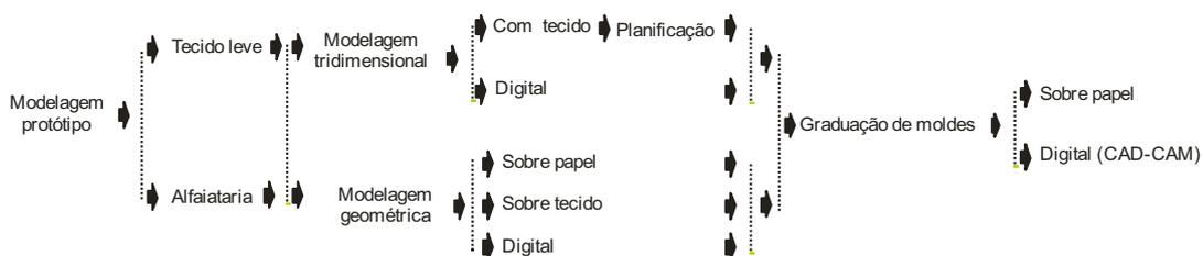
FIG. 69 — Esquema de modelagem no sistema de produção em série. Fonte: Arquivo da autora.
