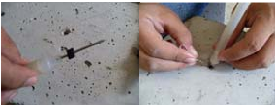
Figura 3.25 – Preparação dos furos para execução do ensaio permeabilidade ao ar.
