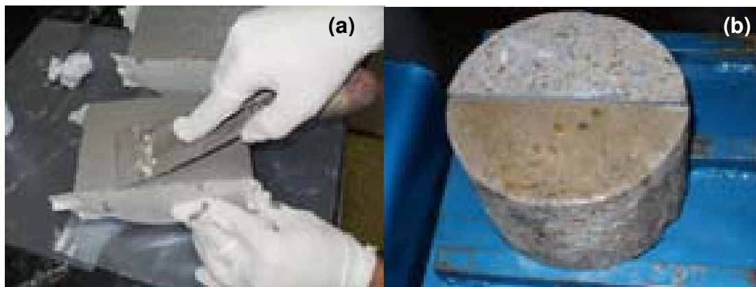
Figura 3.21 – Preparação do corpo-de-prova de penetração de água sob pressão: (a) detalhe da colagem, (b) detalhe do corpo-de-prova já colado.
