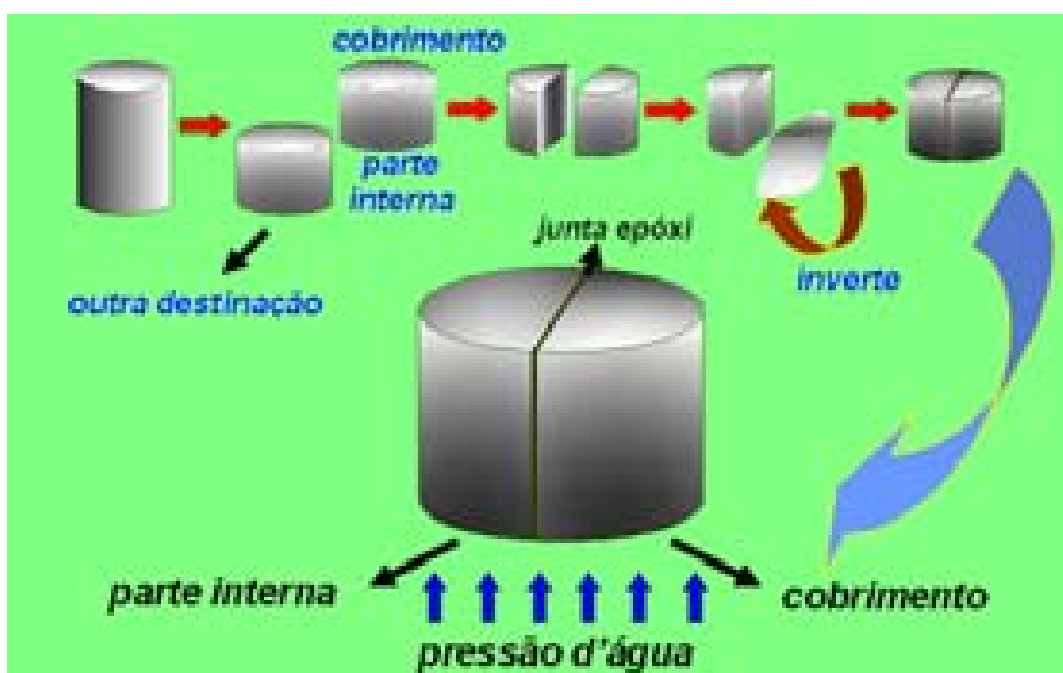
Figura 3.20 – Processo de preparação dos corpos-de-prova para o ensaio de penetração de água sob pressão.
