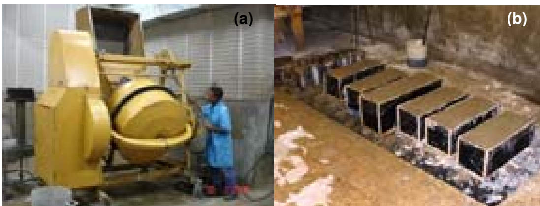
Figura 3.8 – Sala de dosagem do concreto: (a) betoneira utilizada e (b) os concretos no estado fresco referente a um tipo de concreto.
