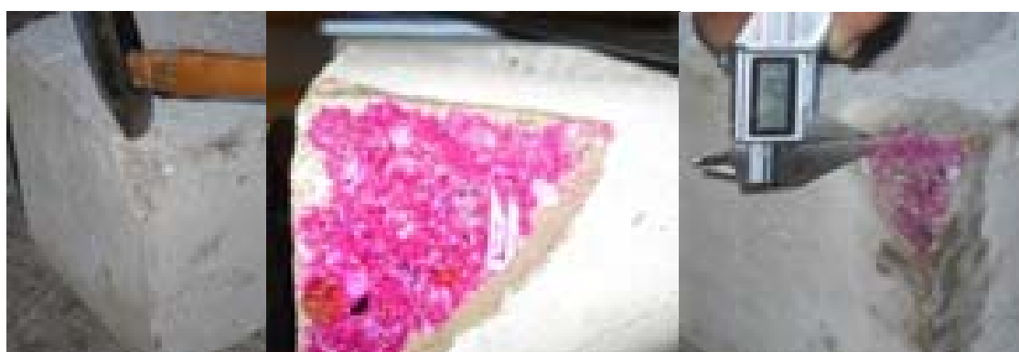
Figura 3.16 – Processo de medida de carbonatação dos concretos.
