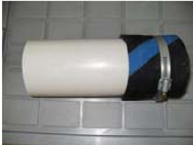
Figura 3.32 – Detalhe da junção da cinta de borracha com o tubo de PVC, formando um “copo” para solução anódica.
