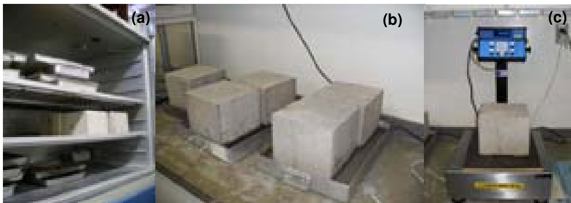
Figura 3.18 – Ensaio de absorção por capilaridade:(a) corpos-de-prova cúbicos de concreto na estufa, (b) os cubos de concreto sendo submetidos ao ensaio, (c) coletando-se a massa da amostra.
