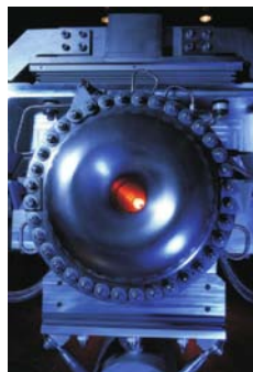
Figura 2.4: Vista através de um dos horns magnéticos do NuMI que focaliza os píons e káons produzidos pela interação do feixe de prótons com o alvo de grafite [31].
