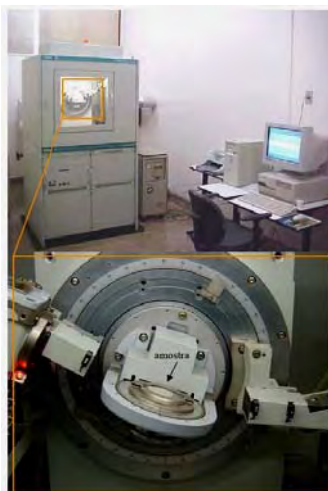
Figura 4.5 – Difratorômetro de Raios-X. Fonte: Oliveira (2008)
