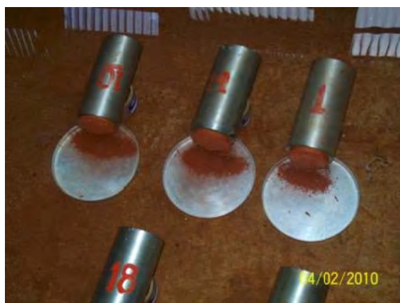
Figura 4.3 – Imersão dos corpos de prova em água. Autor: Batalione (2010)
