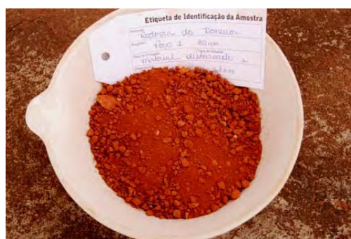
Prof. 3,0 m – material destorroado e passado na # 4,8 mm e composto com a fração pedregulho
