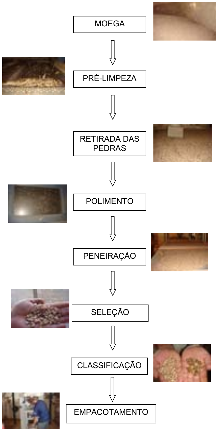
Figura 1. Fluxograma de beneficiamento do feijão.
