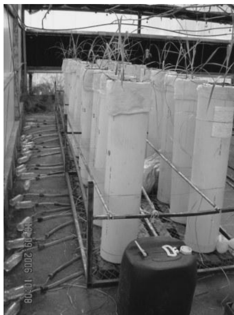
Figura 2. Vista detalhada dos coletores de efluentes acoplados nas colunas de solo.
