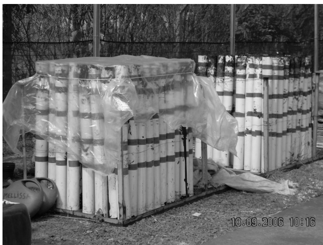
Figura 3. Experimento em colunas para avaliação da movimentação de íons no solo em casa de vegetação.
