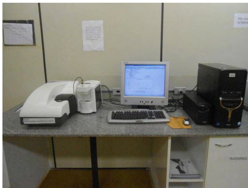
Figura 3.2- Fotografia do ZetaSizer (Nano-ZS, Nano Series) da Central Analítica do Instituto de Química da Universidade Federal de Goiás.
